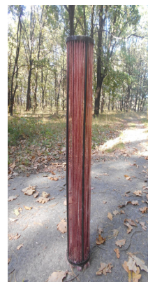
Рис. 9. Лабораторная установка обезжелезивания подземных вод биологическим методом (блок в-волокнистая загрузка БР)
