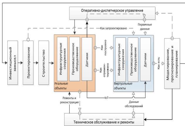
Рисунок 1 – Потоки информации в цифровом двойнике сетей инженерно-технического обеспечения.
